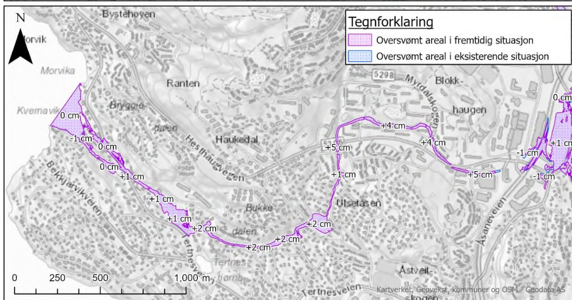
Figur 4-5 Modellert flomutbredelse for eksisterende og fremtidig situasjon ved 200-årsflom inkl. 40% klimapåslag, som illustrerer endringer i flomsituasjonen i Dalaelven. Verdier i kart angir estimert endring i vannstand.
